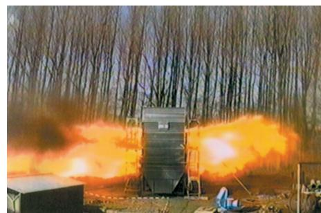
После этого следовала проверка крышек защиты от взрыва, также производимых нами, на устойчивость к толчкам давления и механическую прочность, основываясь на директиве VDI 3673. В последующем ряде измерений были проверены на устойчивость к толчкам давления и безопасность пробоя зажигания и сертифицированы Rippert шлюзы с ячеистым барабаном. Шлюзы с ячеистым барабаном должны выполнять определенные предписания, если они используются для расцепления взрывов.
